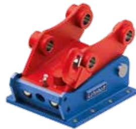
Fest verbunden: Lehmatic-Schnellwechsler und -Adapter
