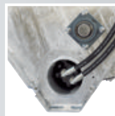
Le moteur d'entraînement du rouleau est bien protégé et l'entraînement direct signifie qu'aucune chaîne d'entraînement exigeant un entretien régulier est nécessaire.
