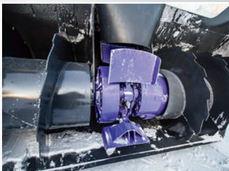
Système de pelle - conçu pour rejeter la neige, une solution qui réduit au minimum le risque d'arrêt intempestif.
