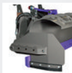
Pare-neige – parfait lors du déblaiement des intersections, des arrêts de bus, etc. quand vous souhaitez arrêter rapidement le débit de neige sur le côté.
