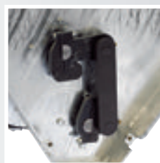
Articulation pour l'utilisation de l'agitateur. Pas de chaîne d'entraînement exigeant un entretien régulier.
