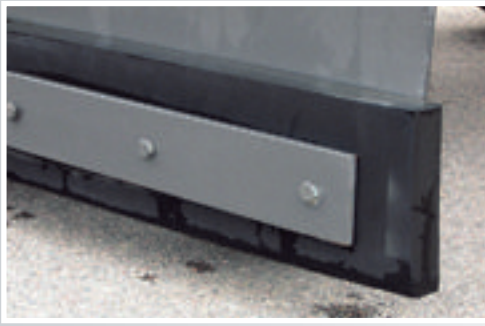
Lame en caoutchouc Une robuste lame en caoutchouc pour le déblayage de la neige molle. La lame est d'une épaisseur de 55 mm et sa résistance à l'usure est supérieure à celle des lames en acier. Garantit un déblayage silencieux et propre. Cette lame est moins appropriée pour la neige dure ou les surfaces gelées.
