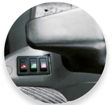
Entsperrbarer Kippschalter zur Betätigung schützt gegen unbeabsichtigtes Entriegeln. Verriegelungskontrolle über Anzeigestift am Schnellwechsler
