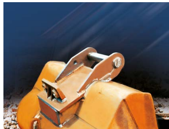
Der Tieflöffel ist nach der Umrüstung bereit für den Einsatz.
