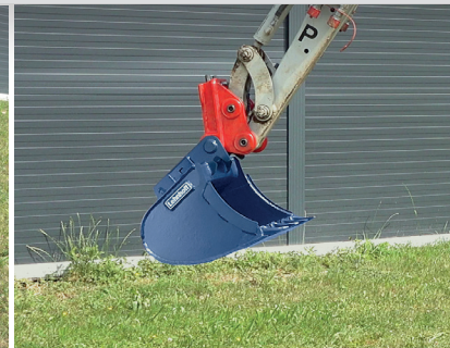
Anbaugerät gesichert in jeder Löffelzylinderposition
