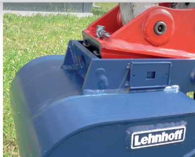
Möglichkeit einer unbeabsichtigten Fehlverriegelung
