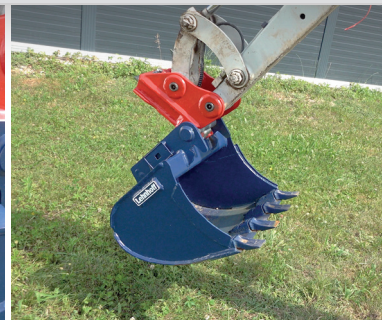
DL-Sicherheitsklaue verhindert Herabfallen des Anbaugerätes
