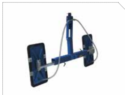
ÉTRIER DE LEVAGE SUR 90 DEGRÉS, BASCULANT, RÉGLABLE ENTRE 1350 – 2350 MM, WLL 900 KG
